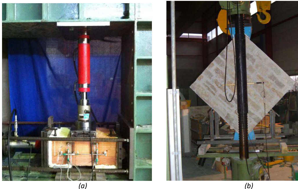
Figura 2. Determinazione della resistenza a taglio (a) su tripletta per murature a blocchi, (b) in compressione diagonale (fessurazione diagonale) su murature irregolari (per es. in pietra).
